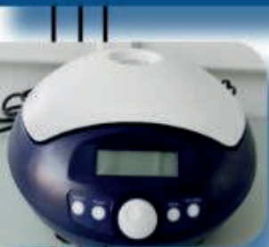
Микроцентрифуга Yicozo D2012 Plus с ротором (на 12 пробирок объемом 1,2/2 мл)
